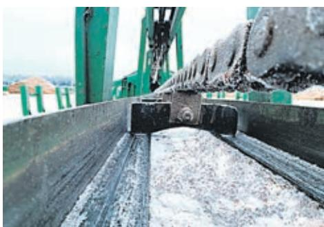
На линии сортировки круглых лесоматериалов Вельского ЛПК установили новые направляющие траверсы — детали,
